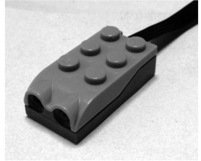
距離センサーを制御ユニットに取り付けます。
