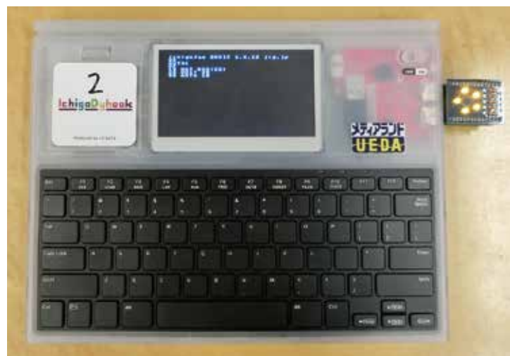
星形にならべた5個のLEDが プログラムで光ります
