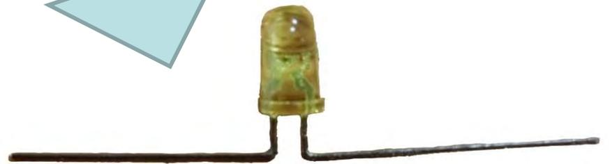
LEDの線を、ラジオペンチで直角に曲げる
