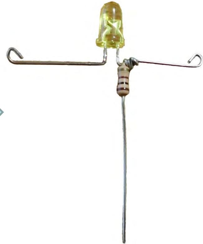
LEDの線が曲がっている所に、抵抗の線を、ラジオペンチできつくまきつける
