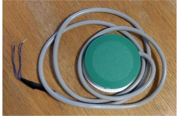
MJ-Dake のソケットの GND 端子と BTN 端子に、大型ボタンの 2 本のケーブルをさします。
